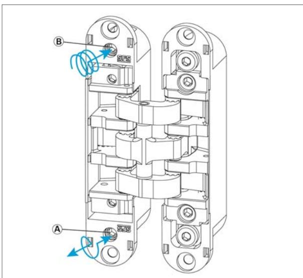
**Regulación en altura** y +/-3 mm: afloje el tornillo A mínimo 3 vueltas y apriete o afloje el tornillo B hasta llegar a la altura deseada. Bloquear apretando el tornillo A.
