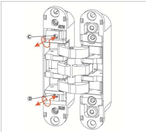
**Regulación lateral** x +/- 3 mm: apretar o aflojar alternativamente los tornillos C y D para aumentar o disminuir el espacio de aire.
