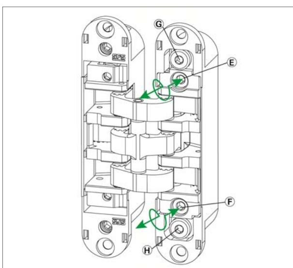
**Regulación presión de junta** z +/- 1 mm: afloje los tornillos G y H. Apriete o afloje alternativamente los tornillos E y F. Bloquear los tornillos G y H.
